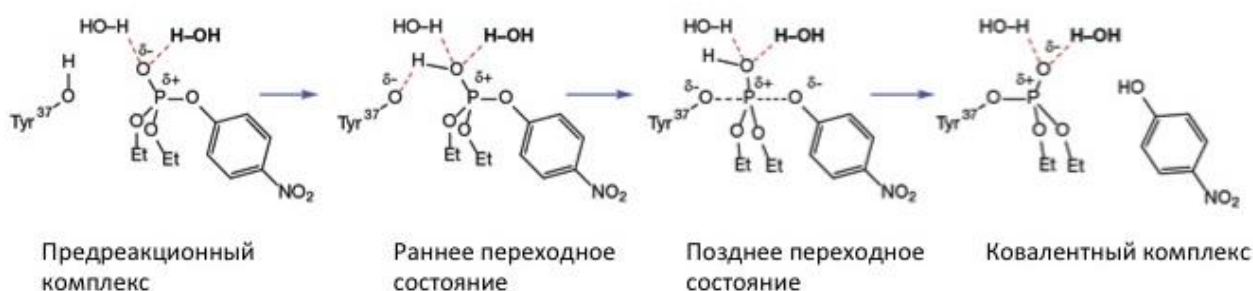
Рис. 10. Квантово-механическое описание стадии образования ковалентного интермедиата в реакции антитела A17 и параоксона.
