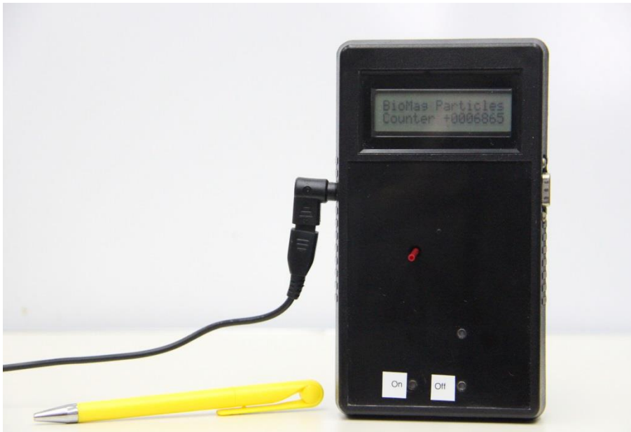
Рис. 18. Фотография оригинального регистратора нелинейных магнетиков (размеры В x Ш x Г: 18 x 10 x 4 см).
