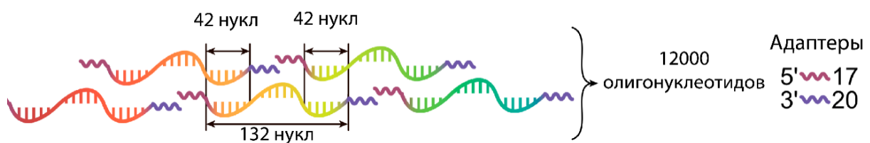
Рисунок 8. Схематическое изображение синтезированной одноцепочечной ДНК-кодируемой библиотеки перекрывающихся олигонуклеотидов. Олигонуклеотиды длиной 132 нуклеотида фланкированы адаптерами и имеют перекрывающиеся участки по 42 нуклеотида.
