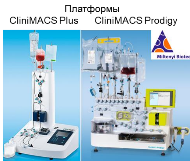
Рисунок 46 – Состав системы для наработки CAR19 Тm клеток; CliniMACS Plus служит для обеднения или обогащения исходного клеточного материала определенными клеточными популяциями за счет магнитных шариков со стрептавидином и коктейля биотинилированных
